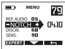
Le Notch est un complément à la discrimination, il permet de rejeter une fenêtre de cibles alors que la discrimination rejette toutes les cibles en dessous d'un seuil.
