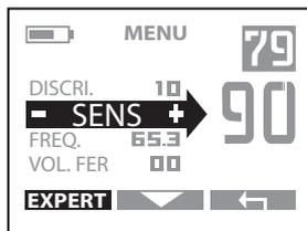
Dèus vous permet de régler la puissance du champ électromagnétique émis sur 3 niveaux, de **1 à 3** (3 étant le niveau maximum).
