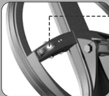
La LED sur le disque vous indique son réveil et son calibrage par **20 flashes longs successifs**. Une fois le calibrage effectué, le disque devient opérationnel et se met à flasher **chaque seconde**.
